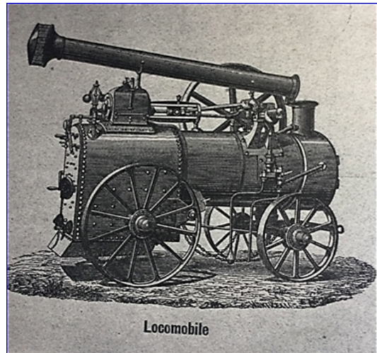
FIG. 9 Il locomobile, una macchina di Watt munita di camino.
