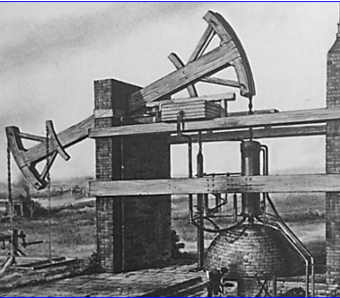
FIG. 6 Macchina a vapore Newcomen, chiamata "L'Amico del minatore". Sulla destra la caldaia e il cilindro verticale con lo stantuffo che, spinto dal vapore, fa oscillare la trave orizzontale. Sulla sinistra l'imboccatura della miniera e la stazione di pompaggio.
