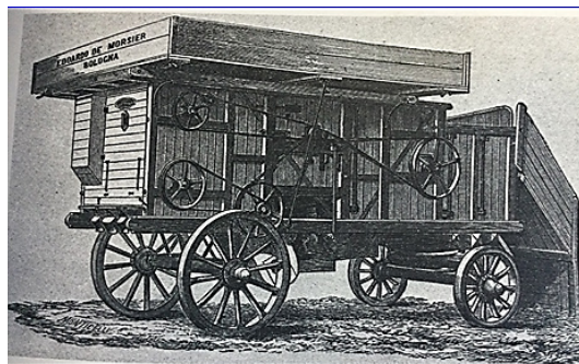
FIG. 10 La trebbiatrice collegabile al locomobile tramite cinghie
