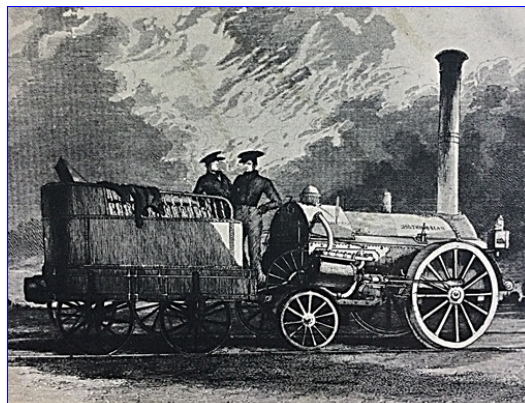
FIG. 15 Locomotiva Rocket con caldaia a tubi orizzontali
